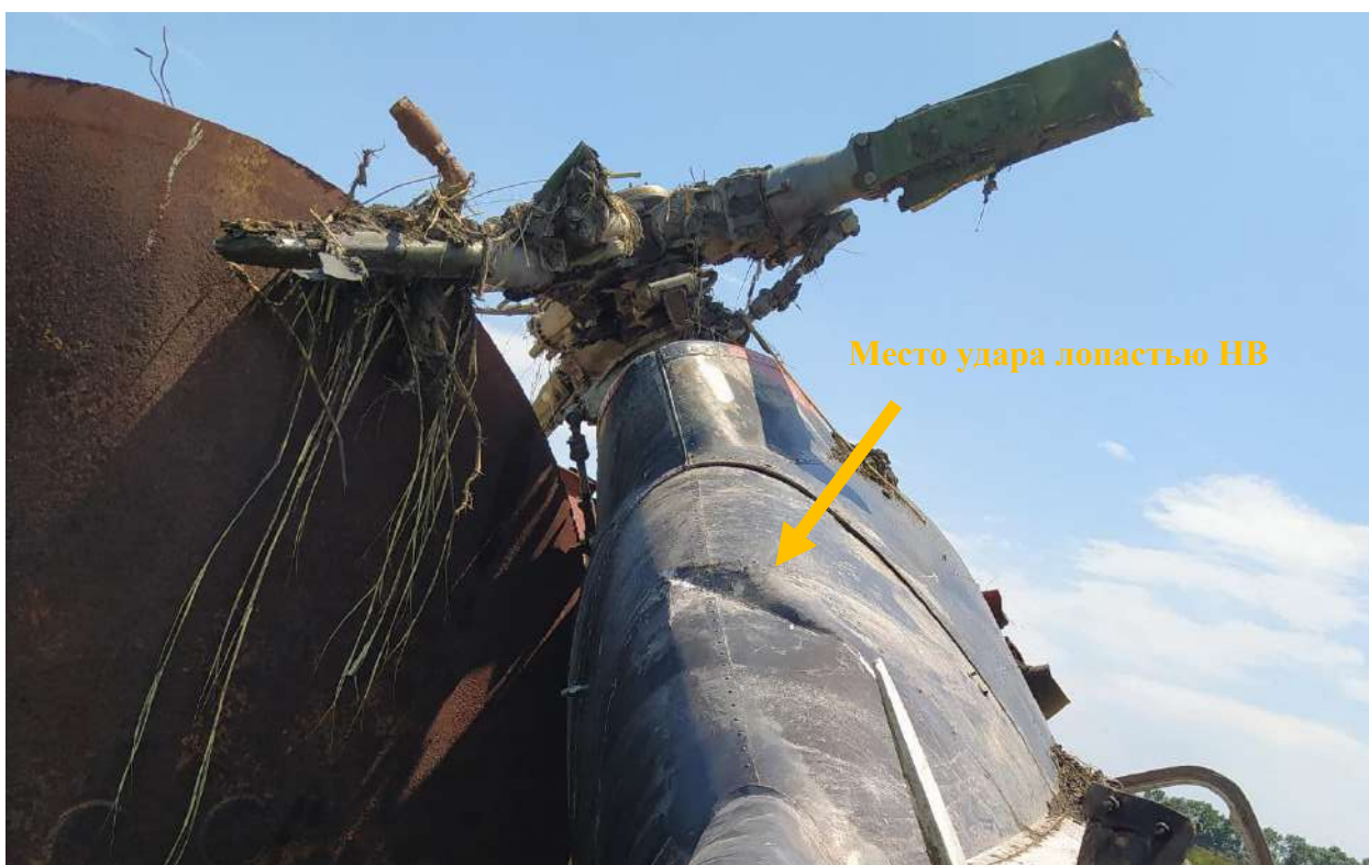
Рис. 2. Повреждение фюзеляжа вертолётa Ми-2 RA-15746
